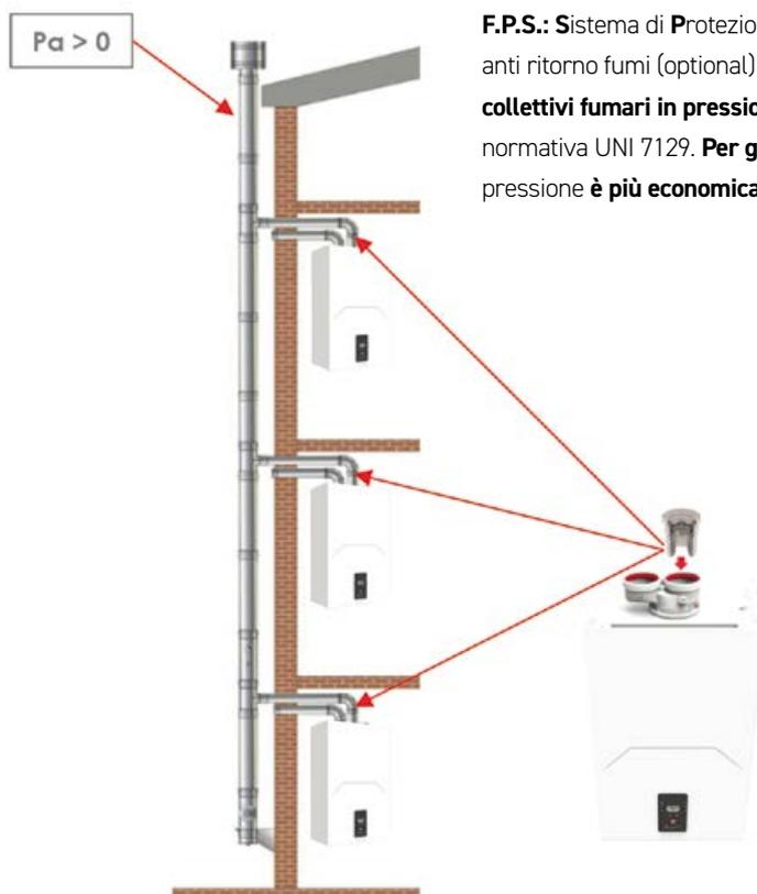
**F.P.S.:** Sistema di Protezione Fumi. L'installazione esterna del kit specifico anti ritorno fumi (optional) permette una **facile connessione a sistemi collettivi fumari in pressione** (es. nei risanamenti), in accordo alla normativa UNI 7129. **Per gli installatori** la soluzione della canna collettiva in pressione è **più economica** (riduzione dei diametri dei camini).
