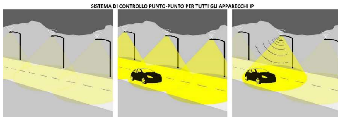
Sistema FAI + Sensore di prossimità - Regolazione del flusso luminoso emesso in funzione del traffico e delle condizioni meteo
